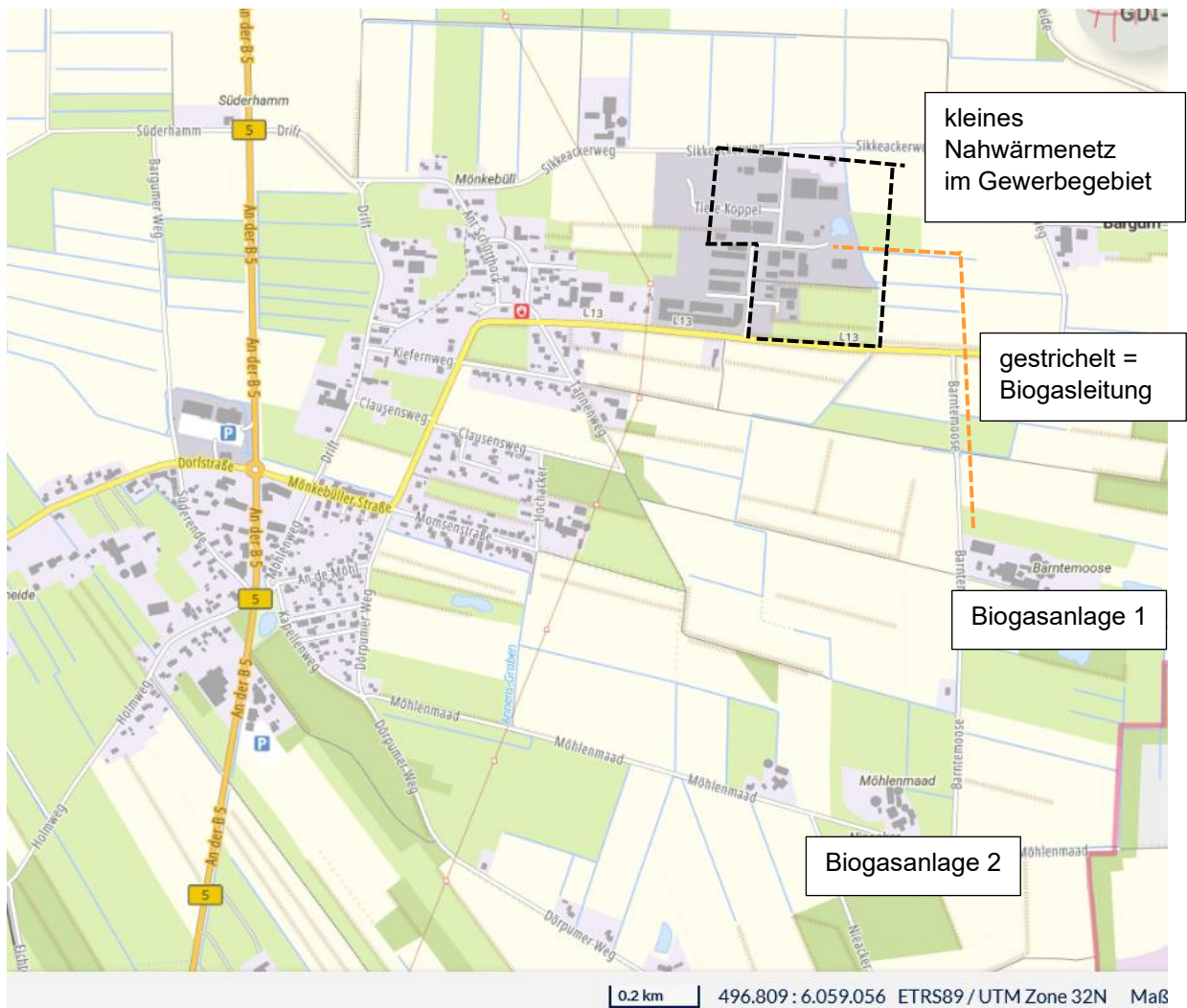
Abbildung 9: zentrale Wärmeerzeugung und bestehendes Wärmenetz
